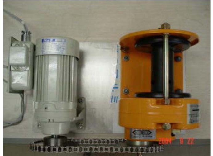
写真 6 ウインチとギアドモーターのセッティング
