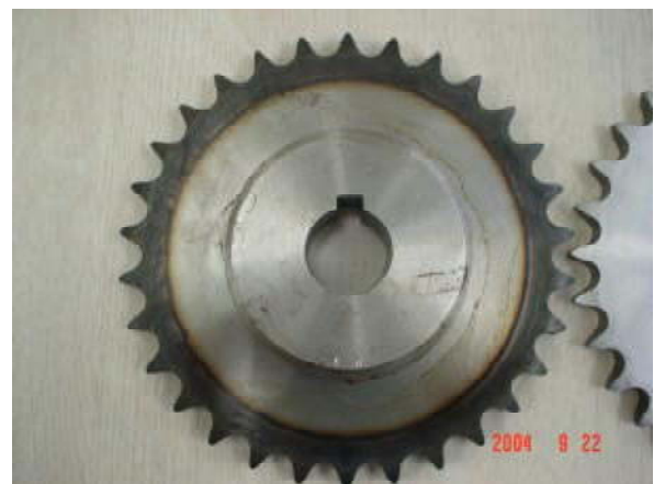
写真 4. モーター側 sprocket のキー溝
